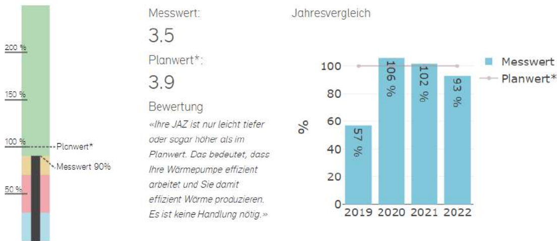
Abbildung 40: MFH Wettingen AG, Auswertung der Jahresarbeitszahl der Wärmepumpe (JAZ) gemäss Monitoring-Demo-Portal [MINMONDEM], Stand Juni 2023
