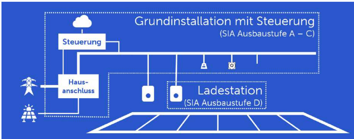
Abbildung 6: Intelligente AC-Ladelösung für Elektroautos für Mehrparteiengebäude
